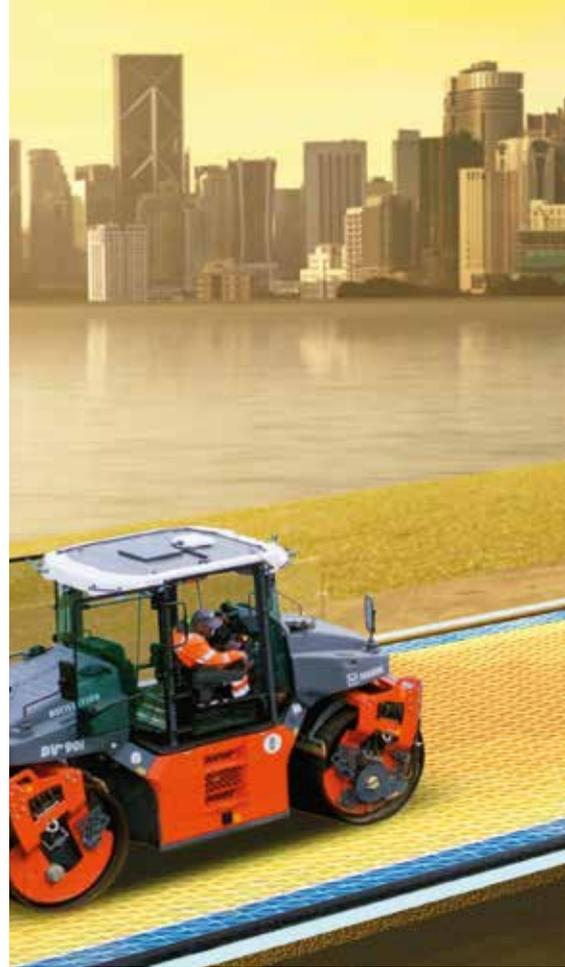
Les technologies de pointe de Vögele optimisent la logistique du chantier et documentent la température de pose : avec WITOS Paving Plus et RoadScan, les équipes de pose régulent l'approvisionnement en matériau, et les entreprises de construction ont entre les mains une preuve concrète que le revêtement a été posé dans la bonne fenêtre de temps.
